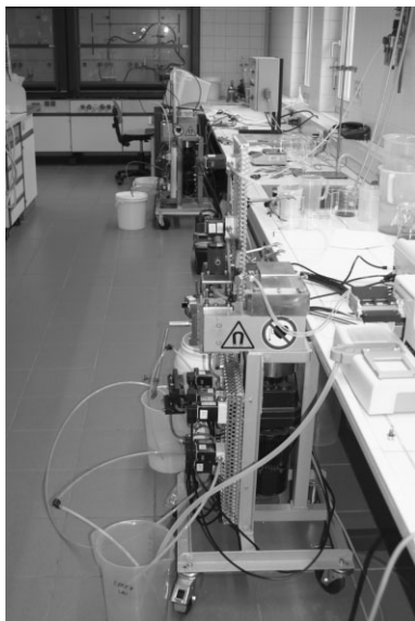
Abbildung 1. Zwei Magnetfilter HGF-10 der Firma Steinert Elektromagnetbau GmbH für den Einsatz in der Bioverfahrenstechnik am Umwelt-Campus Birkenfeld.
