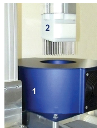
Abb. 2: chemagic Magnetic Separation Module I mit 96 magnetisierbaren und rotierbaren Metallstäben, die in die Lösung mit magnetischen Beads eintauchen. 1: Elektromagnet, 2: Separationskopf mit 96 Metallstäben
